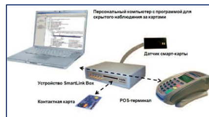
Инструмент для скрытого наблюдения за картами – конфигурация для контактных карт
