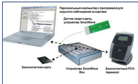
Скрытое наблюдение за передачей данных между бесконтактной картой и терминалом – Активный режим
